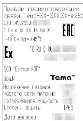
Рисунок 4 – Вид маркировочной этикетки прибора
